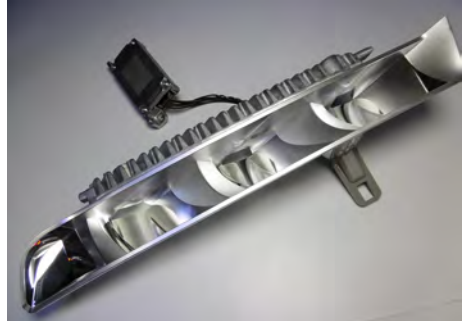
Tagfahrlicht, vermutlich VW, mit geöffnetem Steuergerät
